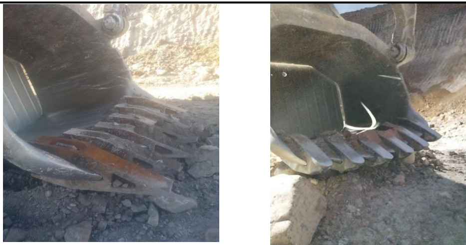
1-rasm. Cho'mich kesuvchi elementlarining hajmiy yemirilish holati a) dastlab o'rnatilgan holati va b) ishlashga yaroqsiz holati
