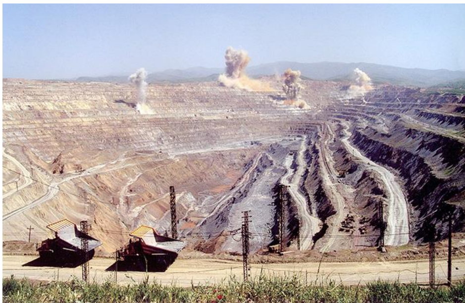
1-rasm. Karyerlarda tog' jinslarini portlatib massivdan ajratish jarayonida atmosfera havosiga chiqadigan zaharli gazlar
