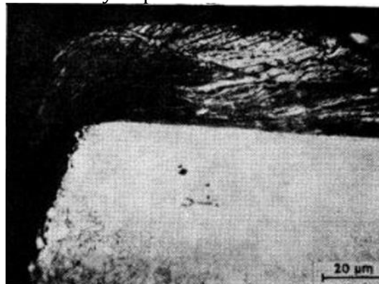
Рис. 1. – Сечение по наросту на твердосплавном инструменте после обработки резанием серого чугуна с пластинчатым графитом.
